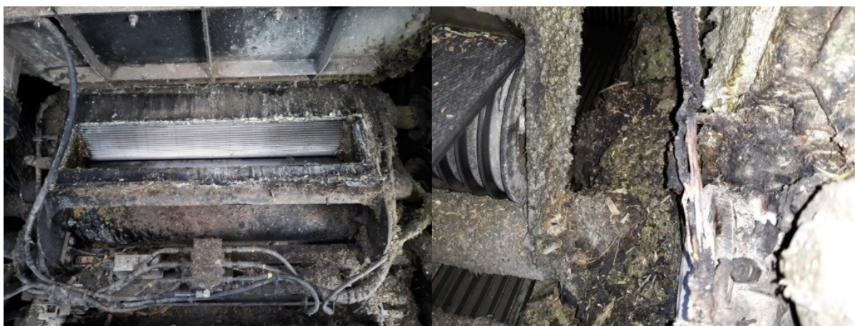
Рисунок 5 – Загрязнение доизмельчителя кормоуборочного комбайна
